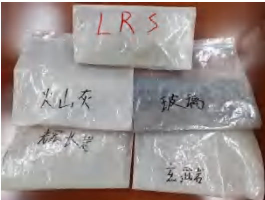
图 2 制备人造月壤相关原材料和人造月壤
