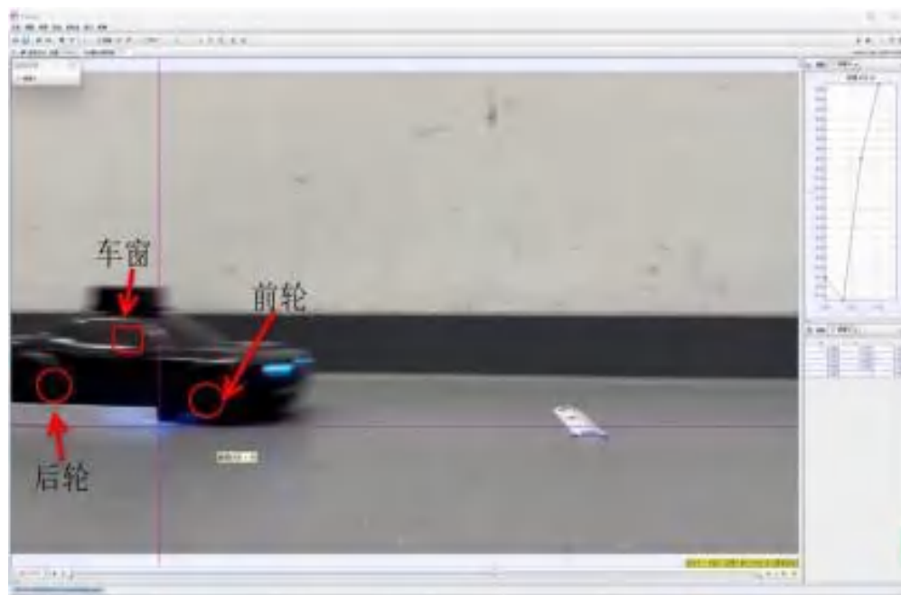
图 3-8 Tracker 软件分析车辆车窗、前轮和后轮经过减速带时的竖直位移变化 使用 Tracker 测量模型车的车速，测试三次取均值，数据如下表：
