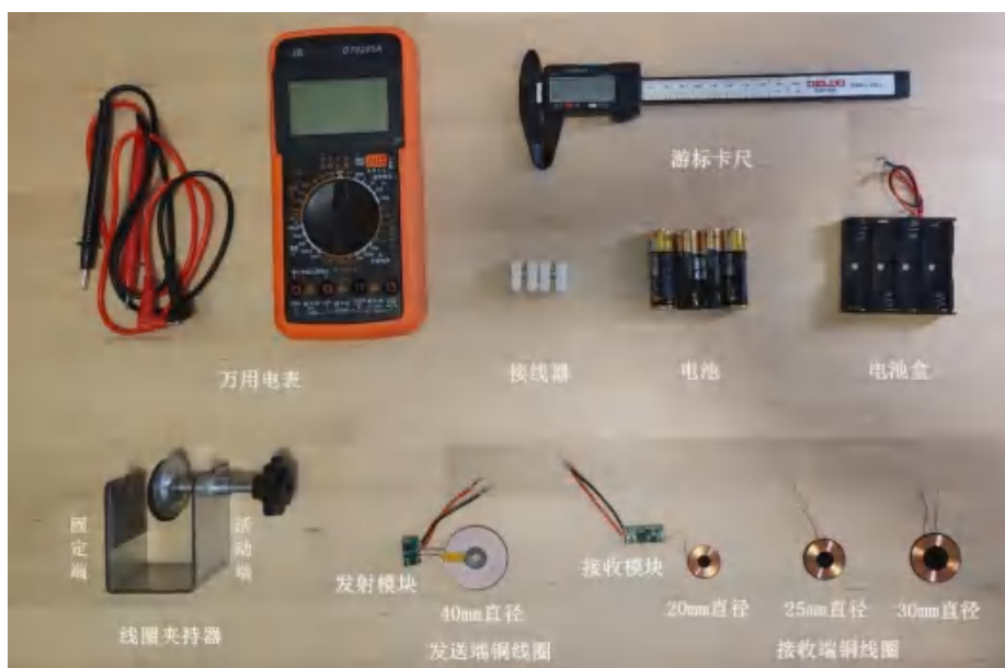
图 2 电磁感应无线供电实验装置的器件和材料
