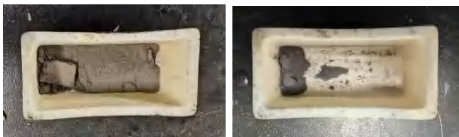
图 4 无预压 800^{\circ}\text{C} 烧结（左）和无预压 1000^{\circ}\text{C} 烧结（右）
